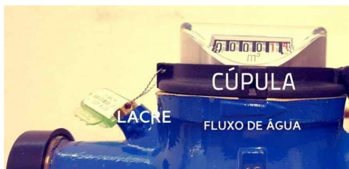
Fig. 04 – hidrômetro analógico
