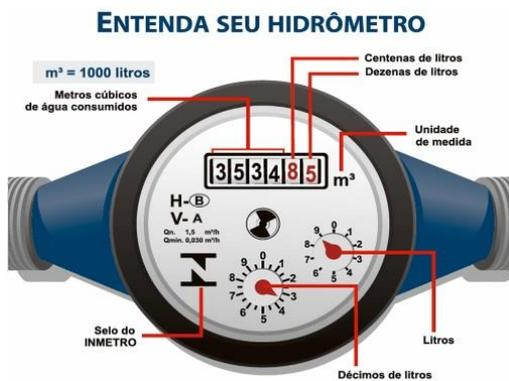
Fig. 02 . leitura do hidrômetro analógico
