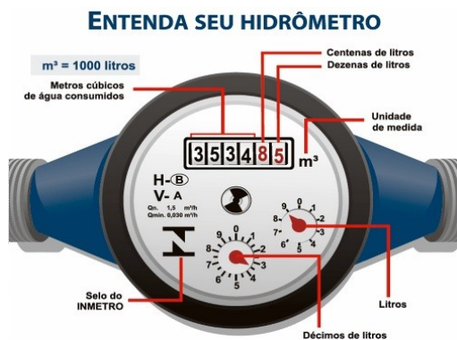
Fig. 02 – leitura do hidrômetro analógico
