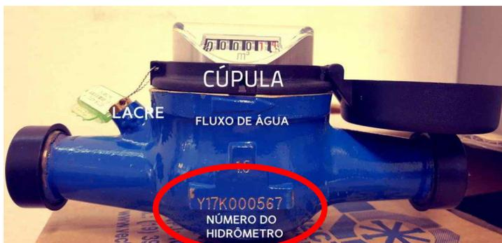
Fig. 04 . hidrômetro analógico
