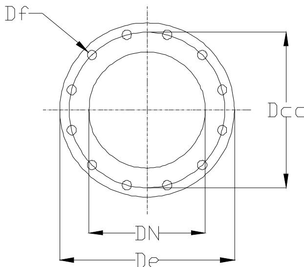
**2.1.2.Tabela 01- Dimensões dos flanges de sucção e recalque da bomba**
