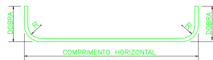
DETALHE DO RAO DE DOBRAMENTO DOS FERROS
