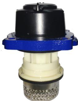
Inovador kit interno de medição equipado com filtro na passagem da câmara inferior para a turbina, inibindo que sólidos em suspensão na água danifiquem o mecanismo de medição do hidrômetro, proporcionando grande efeito de retificação de vazão e protegendo de forma significativa o mecanismo de medição contra golpes de aríete.
