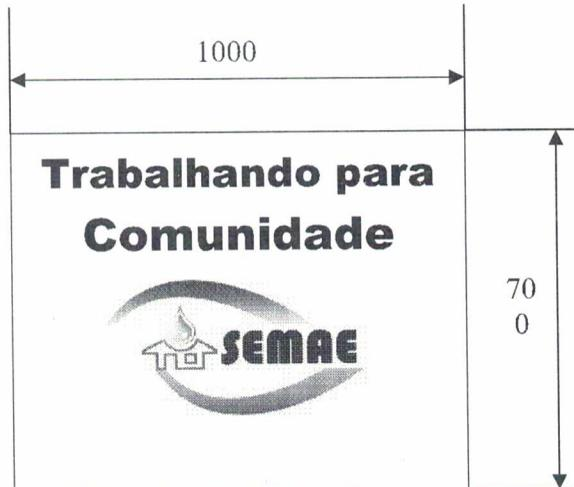
Placa de identificação com 100 milímetros de altura das letras em estilo de letras ARIAL, confeccionada em FIBRA DE VIDRO branco de no mínimo 2,5 mm de espessura.
